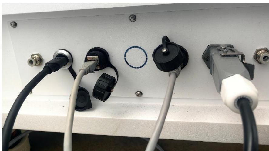
图 9 网线安装参考图
