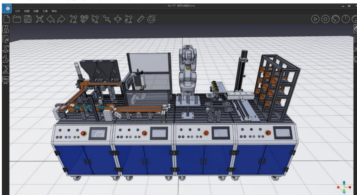
图7 数字化产线仿真设计示意图
